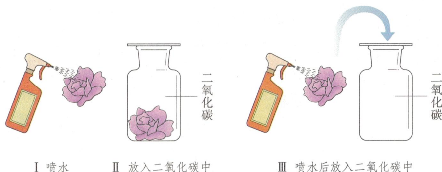
图6-12 二氧化碳与水反应的实验示意图
